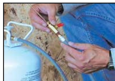
Conecte la manguera y la varilla aplicadora al cilindro.
